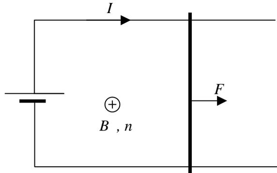
На перемычку действует сила Ампера  $F = IlB$ . При перемещении перемычки вправо на  $dx$  эта сила совершает положительную работу
